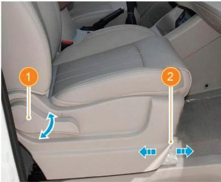
1. Рукоятка регулировки угла наклона спинки сиденья
