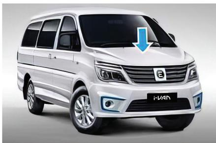
Если автомобиль не оснащен пневматическими упорами капота, поднимите капот на высоту около 30 см от закрытого положения, а затем отпустите его, чтобы он захлопнулся под тяжестью собственного веса. Если автомобиль не оснащен пневматическими упорами капота, поднимите капот на высоту около 30 см от закрытого положения, а затем, нажимая на капот, переведите его в полностью закрытое положение.
