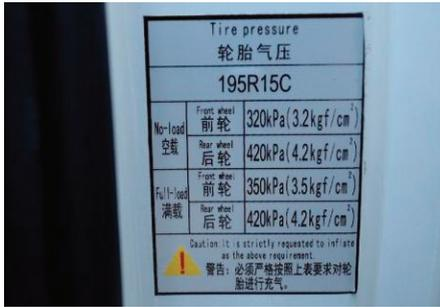
Данная табличка расположена под рамой двери водителя. На ней указано номинальное давление воздуха в передних и задних шинах автомобиля.
