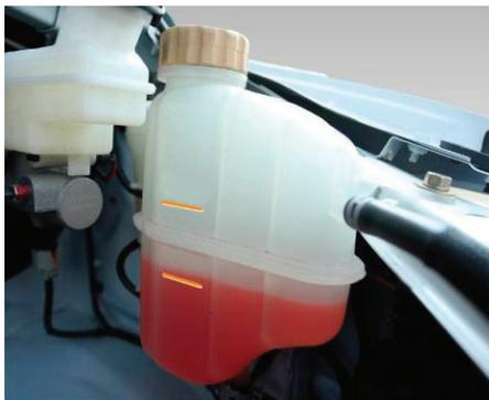
Уровень охлаждающей жидкости должен находиться между верхней (MAX) и нижней (MIN) метками. Если уровень охлаждающей жидкости ниже метки MIN, доведите его до нормы.
