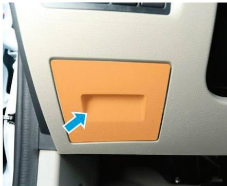
Расположен в нижней левой части передней панели. Для доступа к предохранителям откройте крышку блока.
