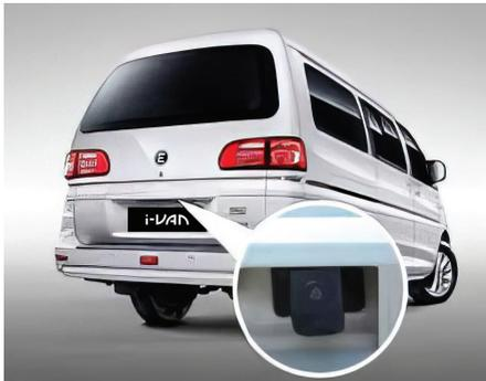
Камера расположена над задним номерным знаком. Камера имеет очень ограниченный обзор. В поле ее зрения не попадают объекты, расположенные за углом или под бампером. Отображаемое на дисплее изображение меняется в зависимости от направления движения автомобиля или дорожных условий. Фактическое расстояние до объекта отличается от того, что отображается.
