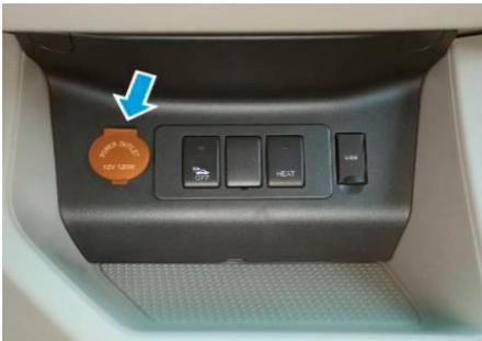
Розетка расположена над вещевым отделением в передней части центральной консоли. Она работает только при включенном режиме питания электрооборудования (бортовой электросети).
