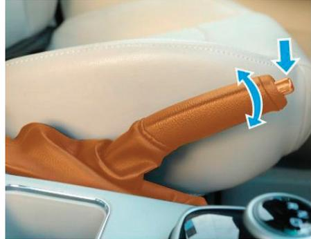
Рычаг стояночного тормоза расположен за селектором. Потяните рычаг стояночного тормоза, чтобы включить его. Это позволит снизить вероятность произвольного движения автомобиля после парковки.
