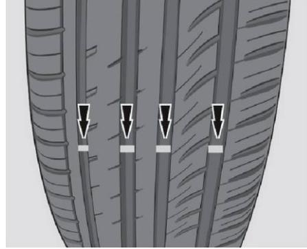
Шина должна быть в хорошем состоянии, а рисунок ее протектора должен быть достаточно глубоким. Степень износа шины можно определить по высоте протектора. Если она меньше или равна 1,6 мм, необходимо заменить шину. При таком износе сцепление с мокрой дорогой не гарантируется.
