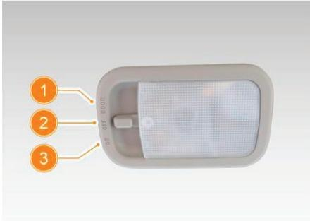
1. Положение включения функции управления потолочным плафоном в зависимости от состояния передних дверей
