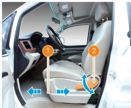
1. Рычаг продольной регулировки положения сиденья
