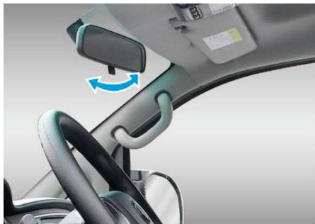
Чтобы переместить внутреннее зеркало заднего вида в требуемое положение, слегка потяните за язычок на нижней кромке его корпуса.
