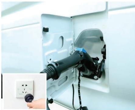
9. При зарядке зарядный пистолет автоматически блокируется в гнезде. Для отсоединения зарядного пистолета после завершения зарядки сначала необходимо нажать кнопку разблокировки.
