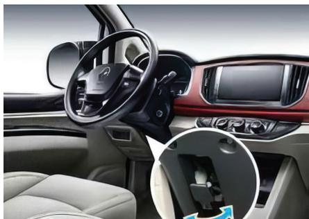
С помощью регулировочной рукоятки на рулевой колонке можно установить рулевое колесо в нужное положение (по наклону). После завершения регулировки регулировочная рукоятка должна быть полностью зафиксирована.
