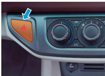
Чтобы включить аварийную световую сигнализацию, нажмите выключатель со знаком треугольника, расположенный под дисплеем мультимедийной системы. Все указатели поворота начнут мигать, оповещая других участников движения о потенциально аварийной ситуации. Индикаторы указателей поворота на комбинации приборов также начнут мигать.
