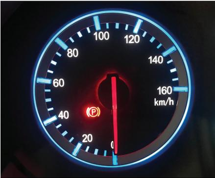
Спидометр показывает текущую скорость движения автомобиля в км/ч. Из-за изменения давления в шинах, состояния дороги, климата и других факторов указанная и фактическая скорость могут отличаться.
