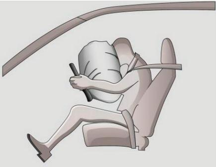
При сильном ударе блок управления подушками безопасности определяет замедление, вызванное столкновением, и принимает решение о необходимости раскрытия подушки. Если решение положительное, то подушка безопасности раскрывается в доли секунды и в сочетании с ремнем безопасности обеспечивает дополнительную защиту головы, груди и т. д.
