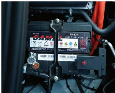
Низковольтная аккумуляторная батарея установлена в правой части моторного отсека. В случае сильного разряда она не сможет обеспечить достаточное количество энергии, необходимое для запуска и эксплуатации автомобиля. Автомобиль оснащен необслуживаемой низковольтной аккумуляторной батареей.
