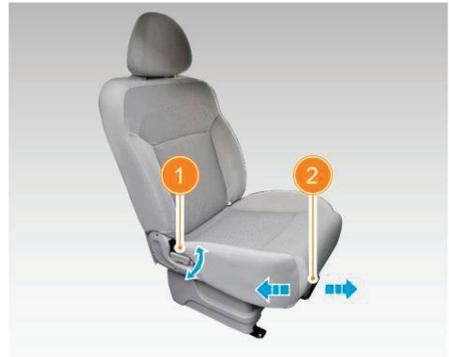
1. Рукоятка регулировки угла наклона спинки сиденья
