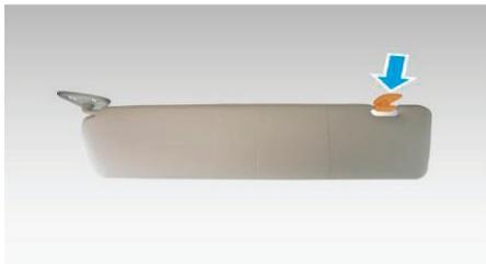
Если обзору вперед мешает сильный солнечный свет, просто откиньте его солнцезащитный козырек вниз, если солнце светит сбоку, сначала отсоедините правую часть козырька от фиксатора, а затем поверните его в сторону.
