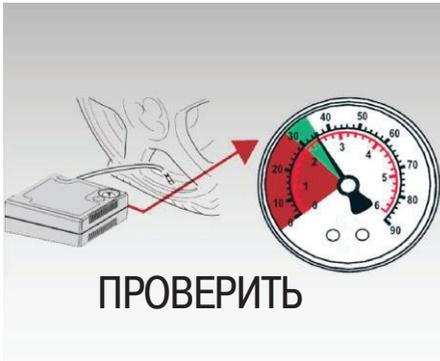
2) Если давление в шине ниже 2,0 бар, снова доведите его до 2,0 ~ 2,5 бар. Проедьте 5 км и снова проверьте давление в шине с помощью манометра.
