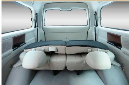
2. Отверните два болта крепления под сиденьем, чтобы отделить сиденье от пола, поверните его набок и прикрепите к потолочному поручню с помощью стропы с фиксатором.
