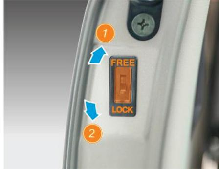
Данная функция помогает предотвратить случайное открывание задней двери во время движения, особенно когда в автомобиле находятся дети. Когда рычаг находится в заблокированном положении ②, функция активна. В этом случае дверь можно открыть только снаружи. Чтобы выключить функцию, переведите рычаг в положение ①.
