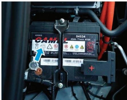
Данная наклейка расположена на корпусе аккумуляторной батареи 12 В. Аккумуляторную батарею 12 В следует хранить вдали от источников тепла и открытого огня. Во избежание несчастных случаев во время зарядки и эксплуатации необходимо обеспечить достаточную вентиляцию.
