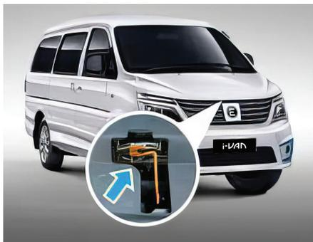
2. Пальцем поверните влево расположенный на передней части капота рычаг замка и поднимите капот.
