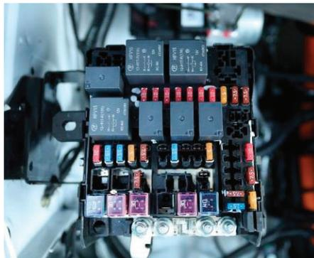
Расположен в передней правой части моторного отсека. Для доступа к предохранителям освободите фиксаторы с левой и правой сторон блока и откройте крышку. Блок предохранителей в салоне
