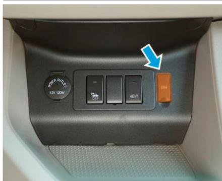
Данный USB-разъем расположен над вещевым отделением в передней части центральной консоли. Чтобы воспользоваться разъемом, сначала снимите заглушку. Зарядка устройств с помощью данного разъема возможна только при включенном режиме питания электрооборудования (бортовой электросети).
