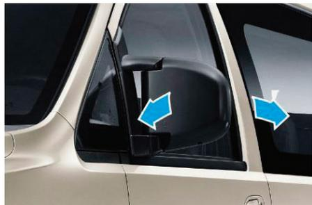
Складывание и раскладывание осуществляются вручную, путем перемещения корпуса зеркала в требуемое положение.
