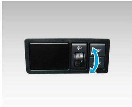
Когда автомобиль загружен, задняя часть кузова опускается и луч лампы ближнего света поднимается, что ухудшает обзор и создает потенциальную угрозу безопасности. Поэтому предусмотрен регулятор, который позволяет изменить высоту лучей фар. Он имеет четыре положения (от 0 до 3). Установите регулятор в требуемое положение, чтобы уменьшить высоту лучей фар соответствующим образом.
