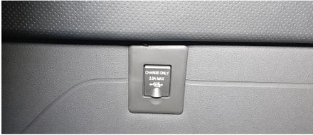
Данный USB-разъем расположен в обивке кузова слева и справа около третьего ряда сидений. Чтобы воспользоваться разъемом, сначала снимите заглушку. Зарядка устройств с помощью данного разъема возможна только при включенном режиме питания электрооборудования (бортовой электросети).
