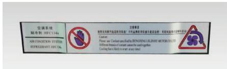
Данная наклейка расположена на внутренней стороне капота. Следует использовать охлаждающую жидкость, рекомендованную компанией Evolute. Смешивать охлаждающую жидкость разных марок нельзя. Не прикасайтесь к радиатору. Вентилятор системы охлаждения может включиться в любой момент.
