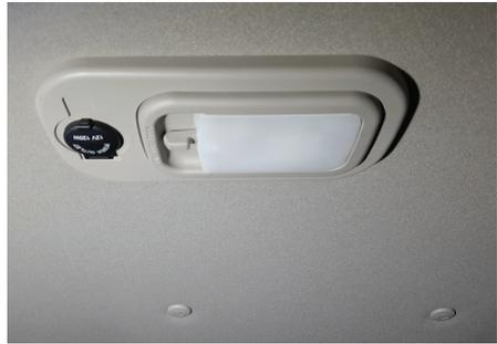
Розетка расположена в плафоне освещения багажника. Она работает только при включенном режиме питания электрооборудования (бортовой электросети).
