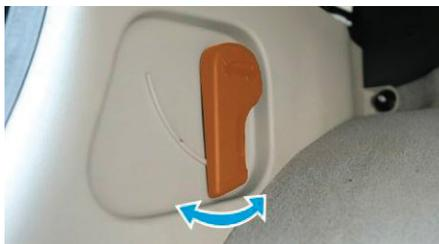
1. Потяните рукоятку открывания капота, расположенную на нижней облицовке левой передней стойки кузова. Капот приоткроется.
