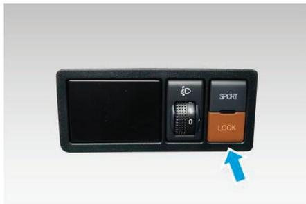
Блокиратор гнезда зарядки переменным током расположен на торце зарядного пистолета. После начала зарядки или разрядки пистолет автоматически заблокируется в гнезде. Чтобы извлечь пистолет, нажмите кнопку
